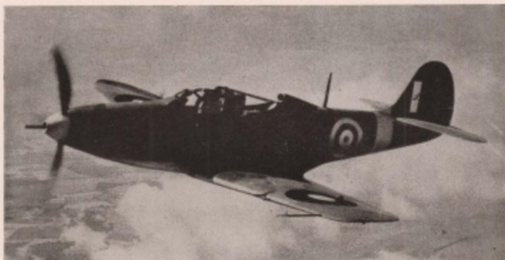
*Die durch die hohle Luftschraubennäse ragende Kanone (bei der R.A.F. Kal. 20 mm, bei USA.-Heeresluftwaffe Kal. 37mm.)*
