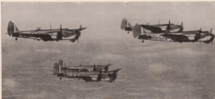
Das Muster Bristol „Blenheim VIII“ unterscheidet sich vom Muster „Blenheim IV“ durch das in einer Wanne unter dem Hauptflug einbaubare Ferngesteuerte, nach rückwärts fessende MG. (Im mittleren Bild besonders gut zu erkennen) und durch eine Schnell-Kraftstoffanlage (s. die Abfußbohrer unter den Flügeln neben den Motorsäugeln).
