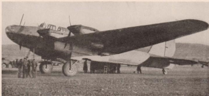
Die Bauartform ist mit n. a. aus 1 Heckland mit 1 beweglichen Kasse, Kol. 20 mes, und MG-Ständen unter den Flügeln in den verlängerten Motorpodelen der inneren Motoren.
