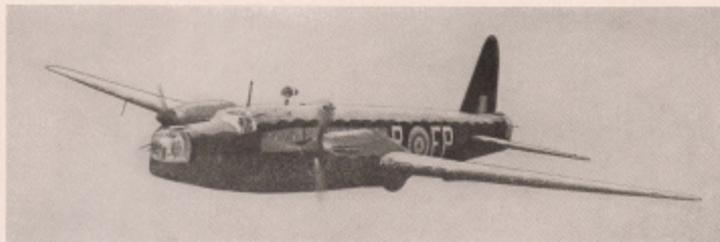
*Avaführung mit 2 Höhenleitwerksblöcken 12 Zyl.-V-Motoren Rolls Royce „Merlin X“.*
