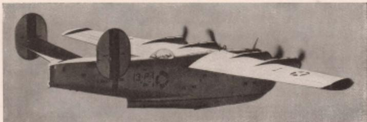
*Je 1 MG-Stand im Rumpfbau auf Rumpfoberseite hinter Flügelkasten und im Rumpfbau hinter dem Leitwerk.
